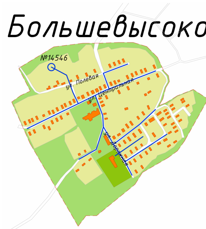
Рис. 5. Зона централизованного водоснабжения д. Большевысоково
