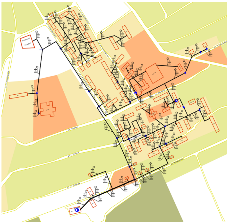
Рис. . Схема тепловой сети газовой котельной.
