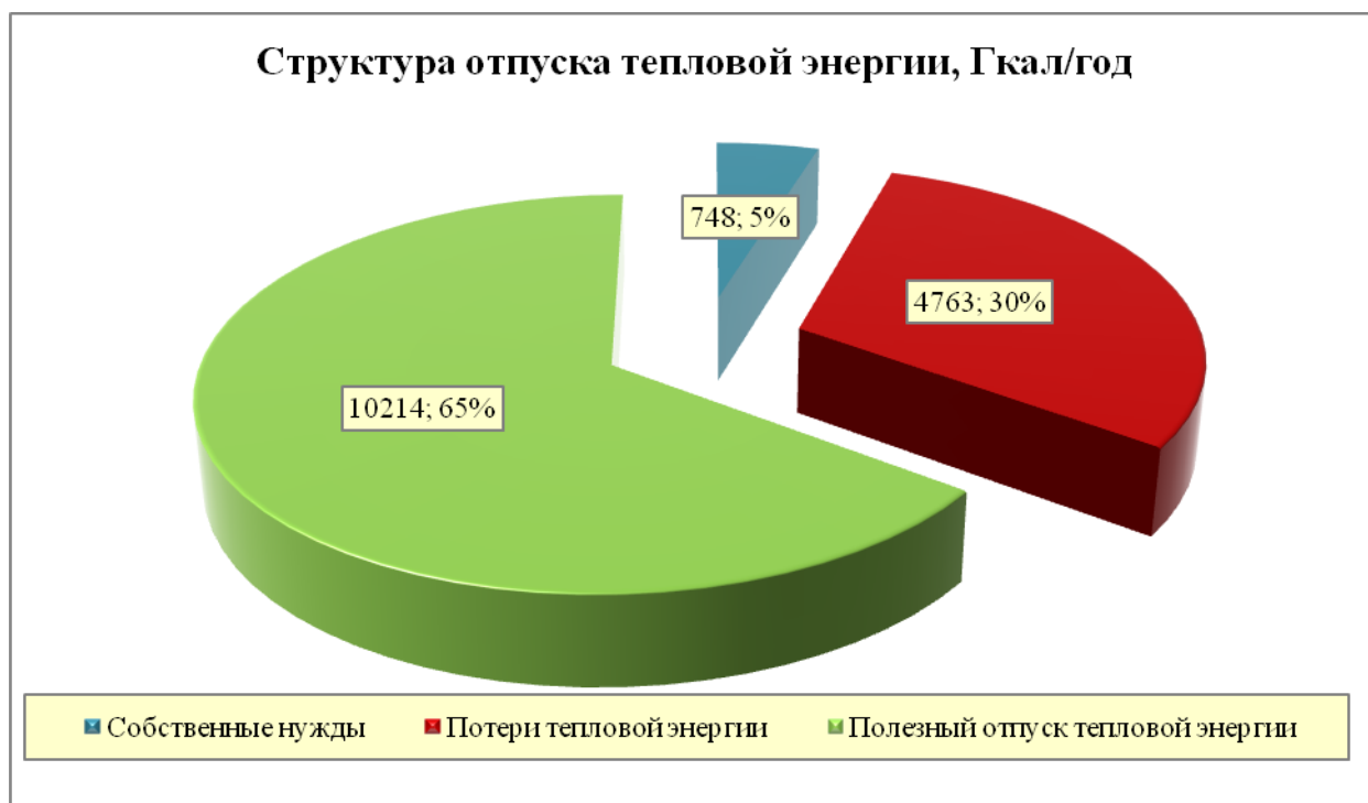
Рис. 2. Структура отпуска тепловой энергии по источникам централизованного теплоснабжения муниципального образования поселок Никологоры
