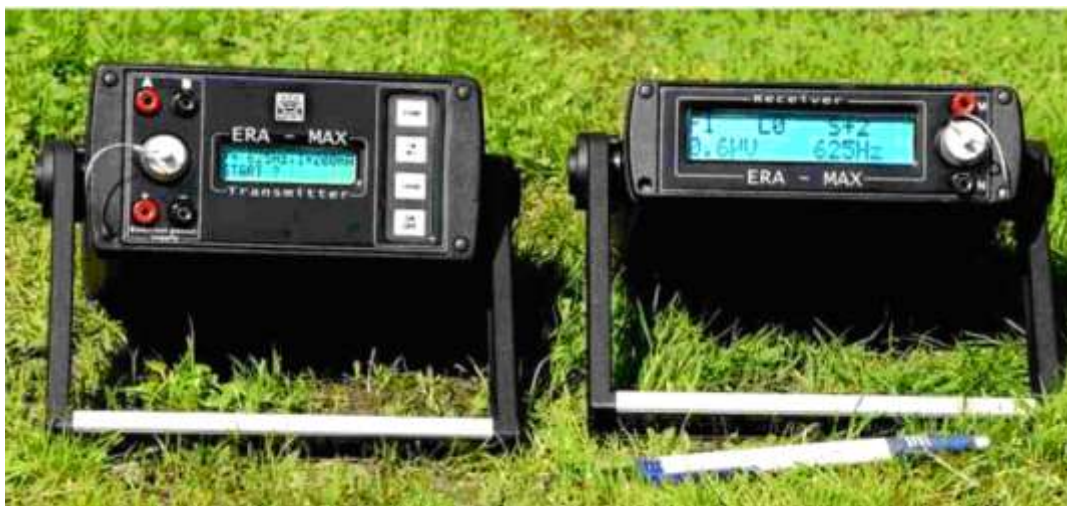
Рисунок 4.1 – Электроразведочная аппаратура ERA-MAX
