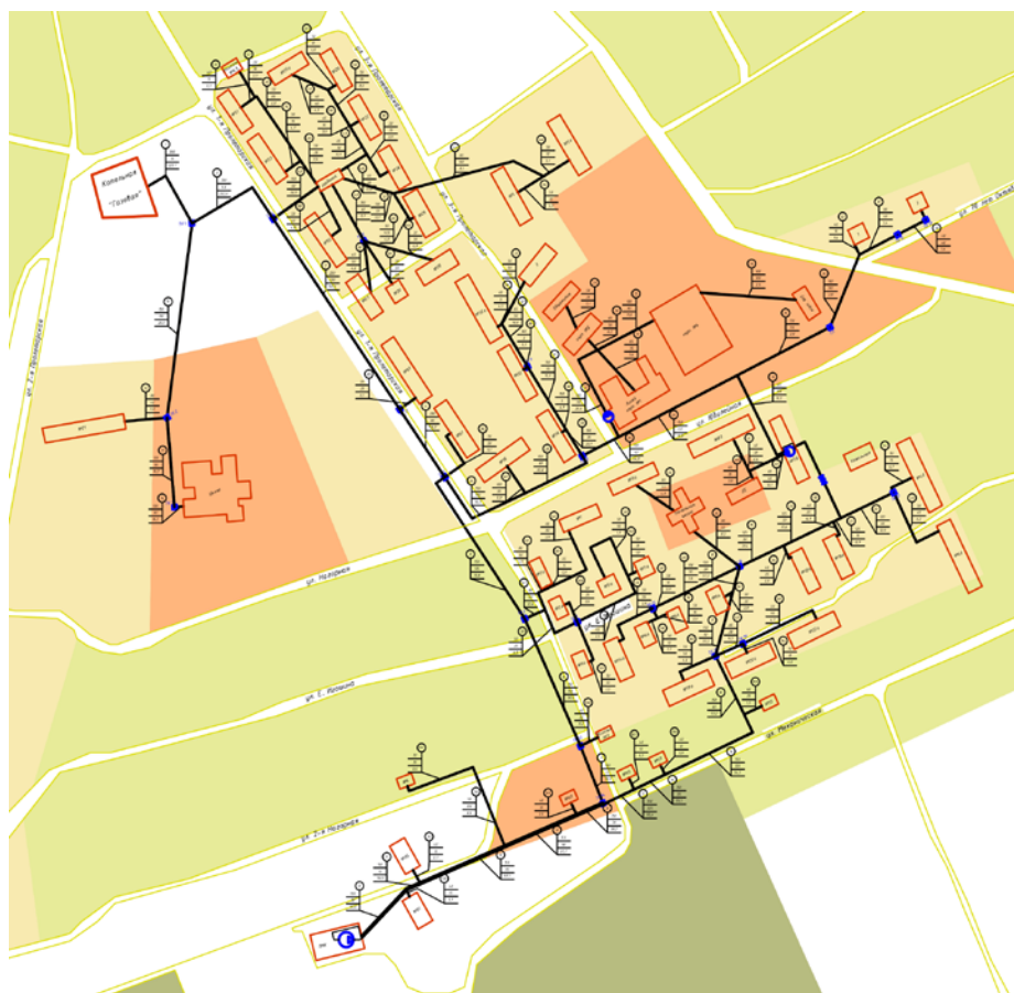
Рис. . Схема тепловой сети газовой котельной.
