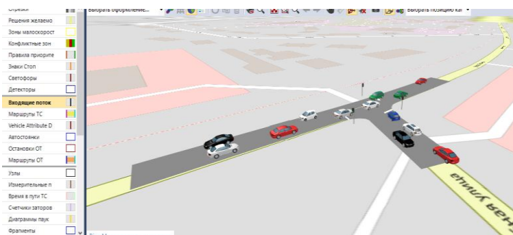
Рисунок 30 – 3D визуализация организации светофорного регулирования на 1500 секунде имитации на пересечении ул.Удобная и ул.Ленина в г.Вязники
