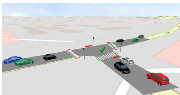
Рисунок 29 – Схема организации светофорного регулирования на пересечении ул.Удобная и ул.Ленина в г.Вязники в имитационной модели
