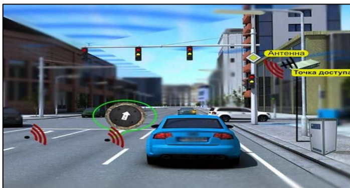
Рисунок 34 – Механизм работы детектора контактного типа
