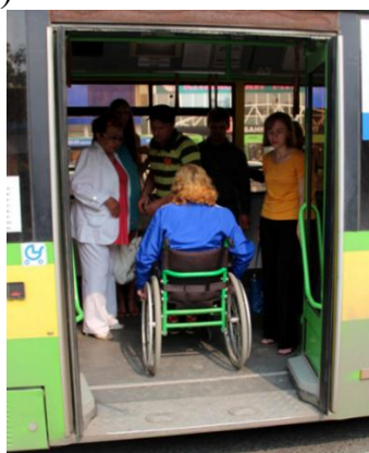
Рисунок 51 – Отсутствие площадки для представителя МГН в подвижном составе
