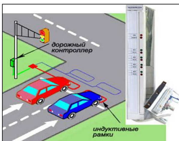
Рисунок 35 – Механизм работы электромагнитного детектора
