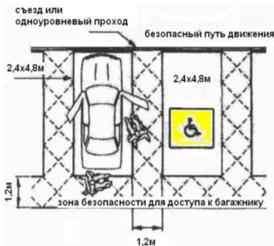
Рисунок 54 – Типовое оборудование парковочного места для МГН перпендикулярно проезжей части
