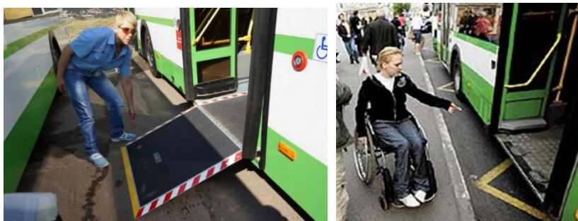
Рисунок 50 – Зазор между транспортным средством и бортовым камнем остановочного пункта
