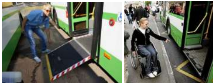
Рисунок 37 – Зазор между транспортным средством и бортовым камнем остановочного пункта
