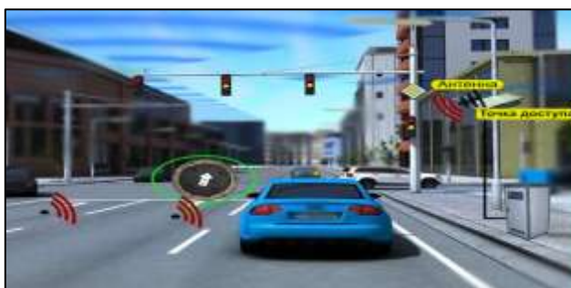
Рисунок 25 – Механизм работы детектора контактного типа
