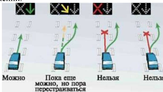
Рисунок 18 – Сигналы дорожных светофоров при реверсивном движении
