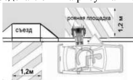
Рисунок 40 – Типовое оборудование парковочного места для МГН параллельно проезжей части
