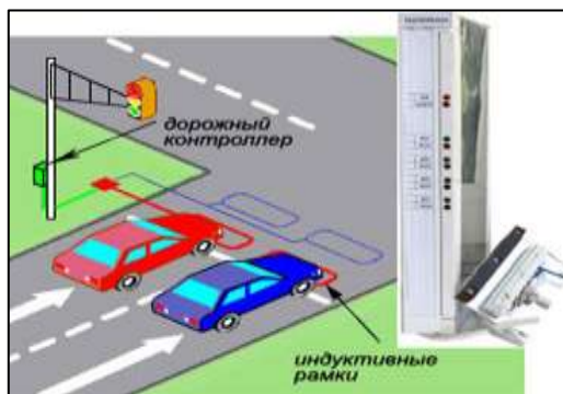
Рисунок 26 – Механизм работы электромагнитного детектора
