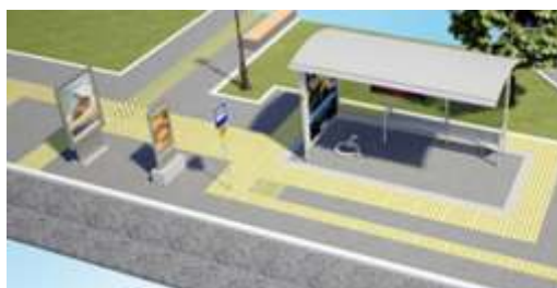
Рисунок 47 – Предложения по расположению тактильной плитки на остановочном пункте
