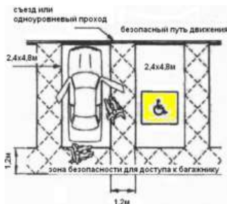
Рисунок 41 – Типовое оборудование парковочного места для МГН перпендикулярно проезжей части
