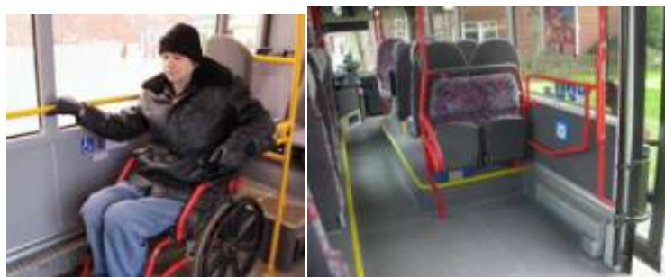
Рисунок 39 – Оборудование подвижного состава для комфортного перемещения МГН
