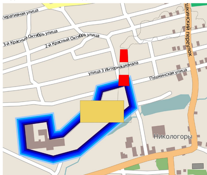
Рис. 10. Зоны действия производственных котельных.
