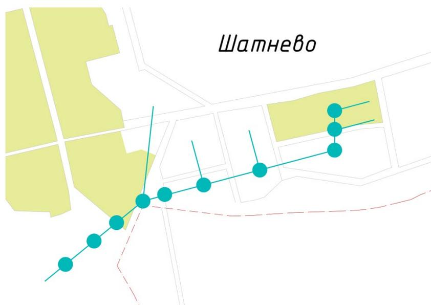
Рис. 13а. Схема водоотведения д. Шатнево
