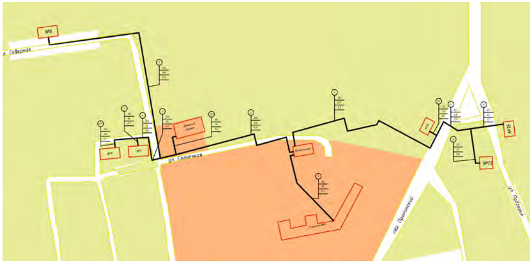
Рис. Схема тепловой сети больничной котельной.
